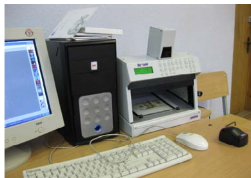
Рис. 3.1. Внешний вид программно-аппаратного комплекса «Regula-4305»
