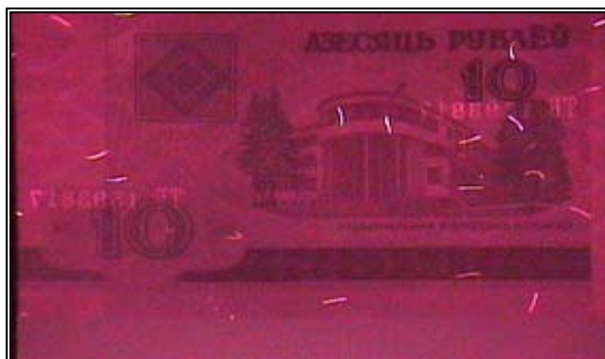
Рис. П.3. Защитные волокна на денежном знаке Республики Беларусь: a - вид под УФ-365; б - вид под УФ-400
