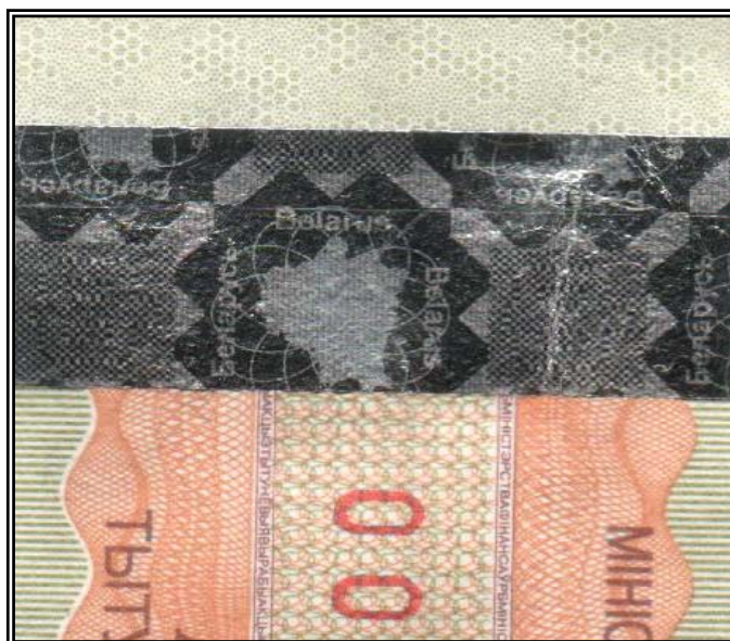
Рис. 2.6. Защита акцизных марок в полиграфическом исполнении: выявление печати скрытых элементов изображения
