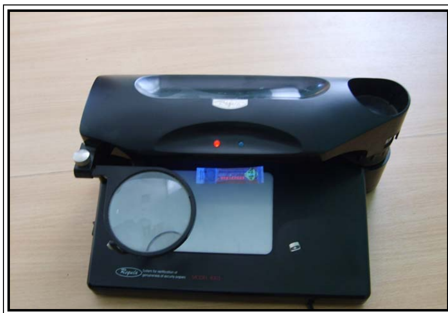
Рис. 2.3. Рассмотрение акцизной марки в поле УФ-излучения на приборе «Regula-4003»
