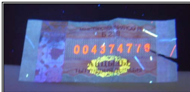
Рис. 2.4. Элемент защиты акцизных марок в специальных материалах: изображение специальных защитных волокон на акцизных марках в УФ-лучах с помощью прибора «Regula-4003». Формат марок: a - 16 × 90 мм; б - 20 × 160 мм
