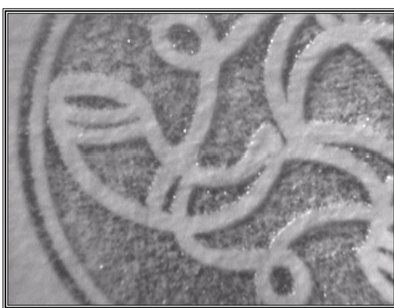
Рис. П.7. Изображение металлографической печати в косопадающих лучах
