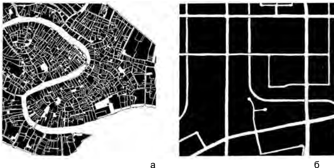
Рис. 24. Фрагменты планировочных структур городов (2,59 км кв.), представленные в одинаковом масштабе: а – Венеция (Италия) – пример исторически сложившейся планировочной структуры, б – Ирвин (штат Калифорния) – результат рурализации
