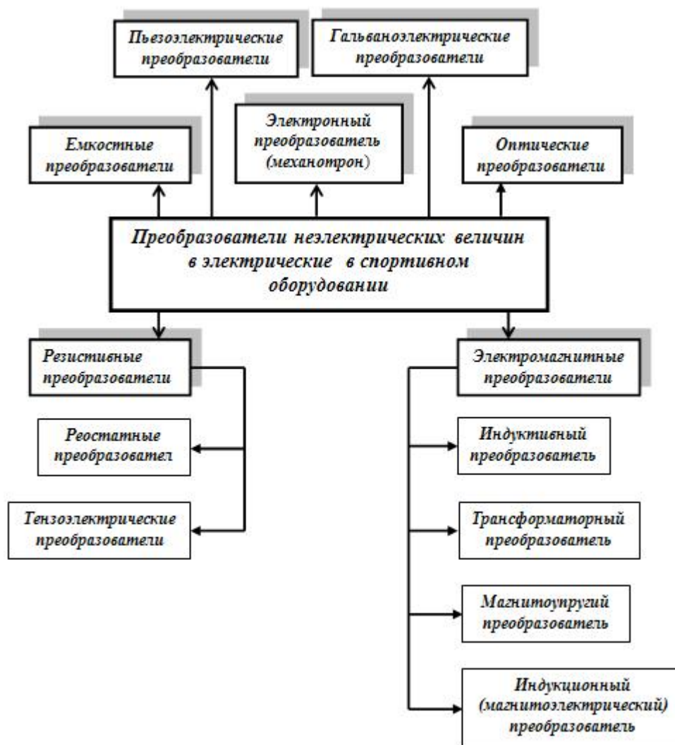
Рисунок 7.5 Классификация преобразования неэлектрических величин в электрические в соответствии с принципом действия тренировочных устройств и спортивных тренажеров
