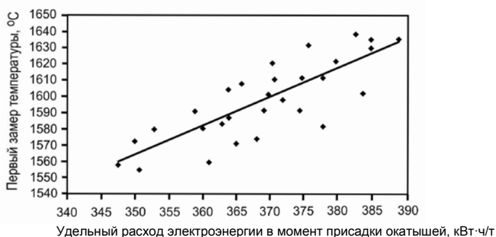
Рисунок 1 – Зависимость начальной температуры металла (первого замера) от момента начала присадки окатышей по варианту II
