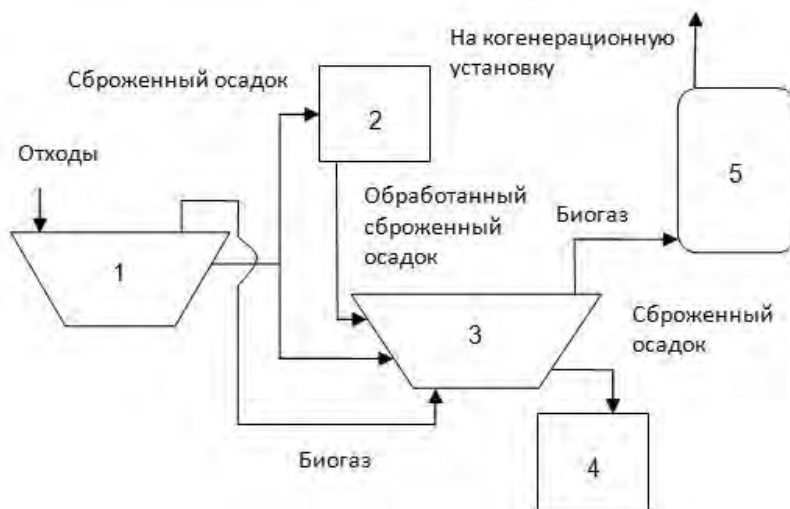
Рис. 1 - Схема утилизации отходов с получением тепловой и электрической энергии:
