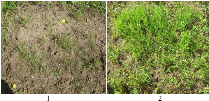
Рис. 1 – Участки мелкodelяночного полевого опыта перед первым укосом трав 1 – почва + нефть; 2 – почва + нефть + композиционный материал + микроорганизмы
