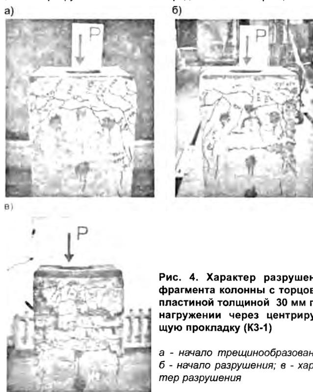
Рис. 4. Характер разрушения фрагмента колонны с торцовой пластиной толщиной 30 мм при нагружении через центрирующую прокладку (K3-1)
