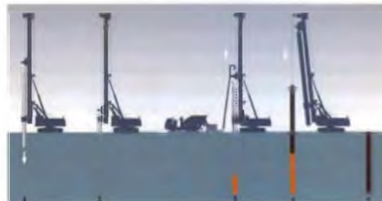
Рис. 1. Технологическая последовательность для установки буронабивных свай по технологии CFA
