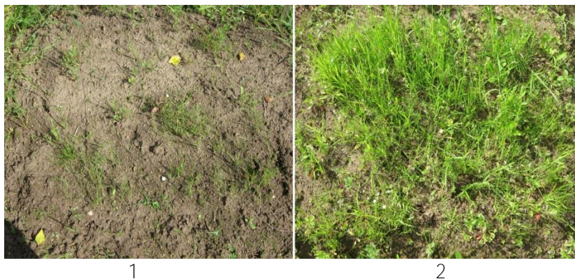
Рис. 1 – Участки мелкodelяночного полевого опыта перед первым укосом трав 1 – почва + нефть; 2 – почва + нефть + композиционный материал + микроорганизмы
