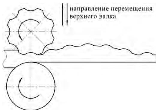
Рисунок 6 – Схема продольной прокатки в валках с периодическим контуром и изменяемым расстоянием между их осями
