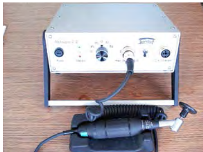
Рисунок 2 – Переносной шлифовально-полировальный станок «Аkkropol 2.2», использованный для подготовки поверхности образцов
