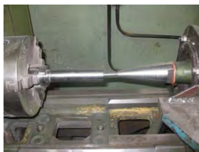
Рисунок 2 – Рабочая зона установки ультразвуковой обработки
