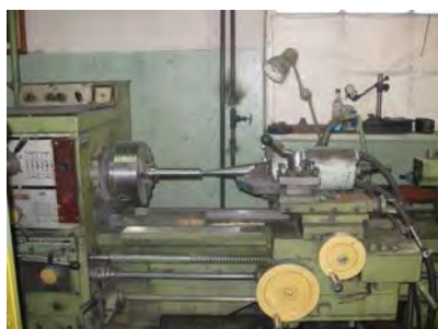
Рисунок 2 – Рабочая зона установки ультразвуковой обработки
