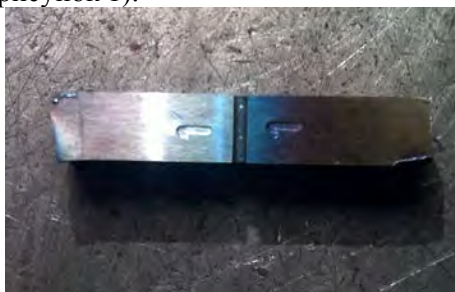
Рисунок 1 – Разогрев образца из стали 40Х при ультразвуковой обработке
