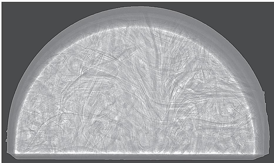
Рис. 1. Рентгеновская проекция фантома Mammography BR3D Phantom для 0°
