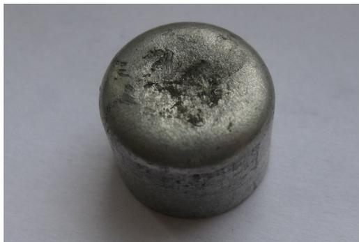
Рисунок 2 – Полученный слиток из сплава Co-Cr-Mo
