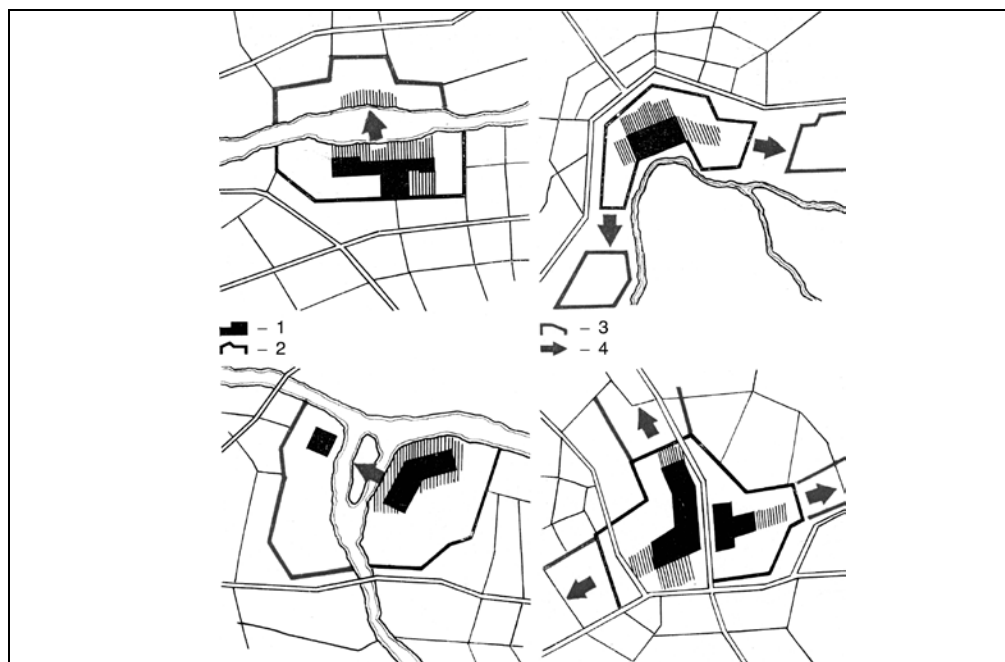
Рис. 1.11. Варианты территориального развития общегородских центров в разных градостроительных и природно-ландшафтных условиях: 1 – ядро общегородского центра; 2 – граница существующего общегородского центра; 3 – граница перспективного развития общегородского центра; 4 – направления территориального развития общегородских центров
