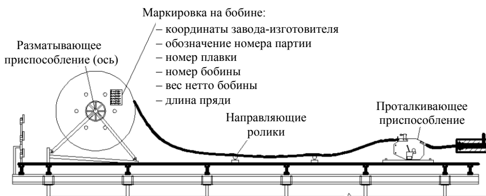
Рис. 4. Размещение оборудования при протягивании прядей
