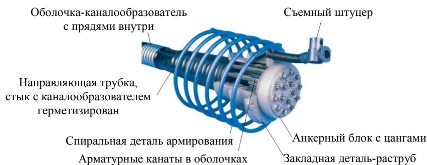
Рис. 3. Принципиальная схема анкерного узла системы multistrand
