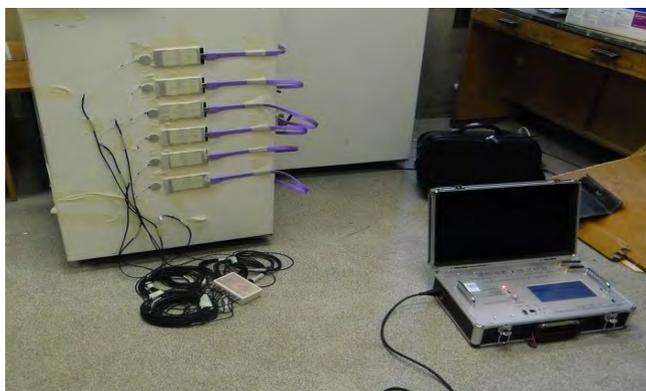
Рис. 1. Многоканальный измеритель плотности теплового потока и температур с беспроводной передачей данных через интернет и программное обеспечение
