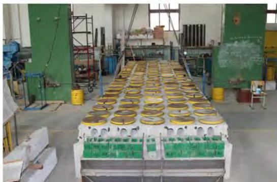
Рис. 1. Экспериментальный образец фрагмента диска перекрытия
