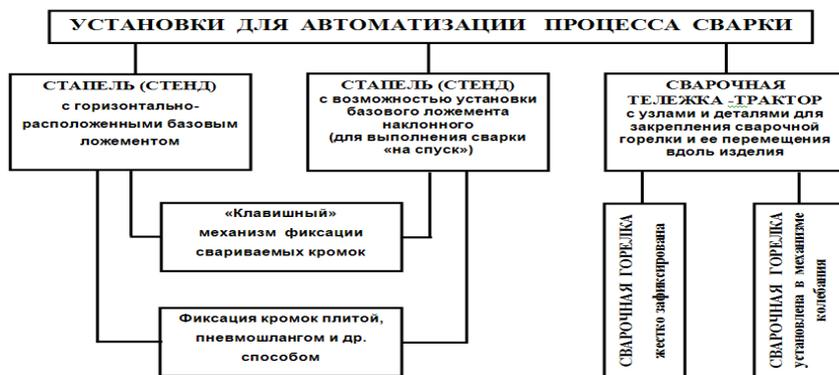
Рис. 1. Классификация установок для автоматизации сварочных процессов
