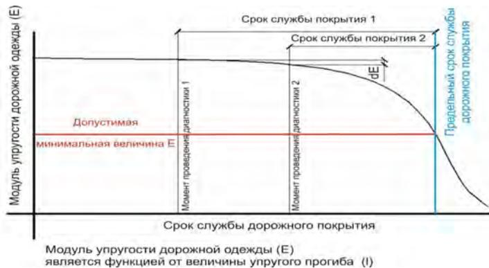
Рис. 1. Схема жизненного цикла дорожного покрытия в узвке с величиной упругого прогиба
