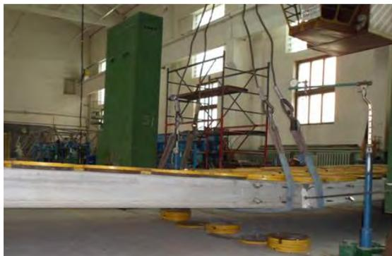
Рис. 2. Работа стыка плит перекрытия после полной передачи нагрузки на фрагмент диска перекрытия
