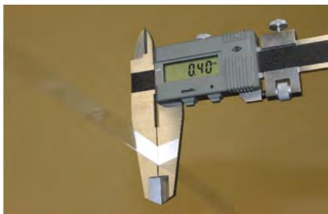
Рис. 1. Лента стекла толщиной 0,4 мм, полученная на экспериментальной установке
