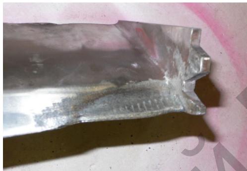
Рис. 3. Восстановленное перо РЛ турбины К-300-23,5 Ленинградского металлургического завода (ЛМЗ)
