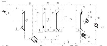
І— Печь с кипящим слоем, ІІ— газовая турбина, ІІІ, ІV— компрессор, V— паровая турбина VІ— конденсатор, VІІ— насос, VІІІ— генератор, ІХ, Х, ХІ, ХІV— теплообменники, ХІІ, ХІІІ— модули ОРЦ либо сетевые подогреватели; 1, 2, 3— потоки воздуха, 4— топливо, 5, 6, 7, 8, 9, 10, 11, 12, 43— дымовые газы, 22, 23, 24, 25, 27, 28, 32— вода 13, 14, 15, 16, 17, 18, 19, 21, 26, 29, 30, 31, 33, 34— пар, 35, 36, 37, 38— механическая энергия, 39, 41, 42— электроэнергия.
