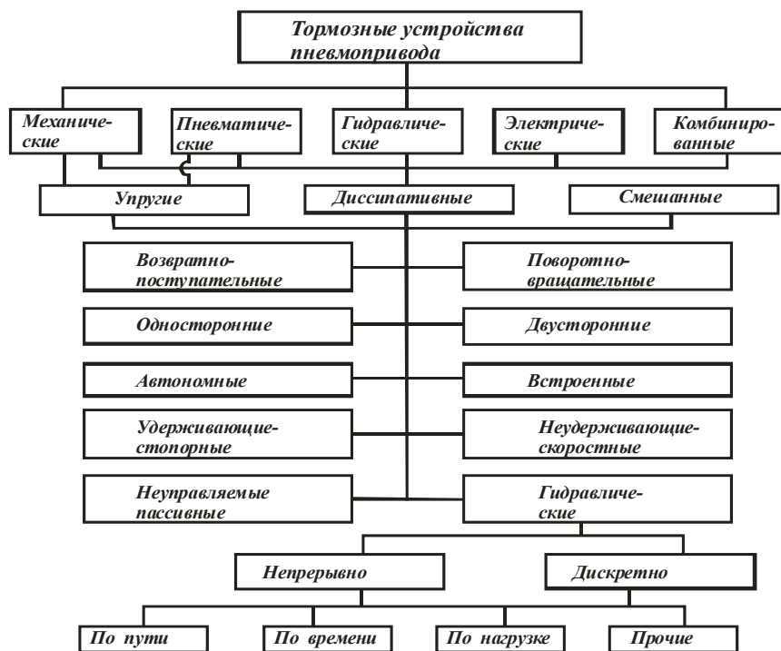
Рис. 5.1. Классификация тормозных устройств
