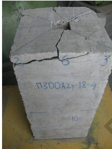
Рис. 2. Характер разрушения образца при передаче нагрузки через штампы сечением 60x60 мм
