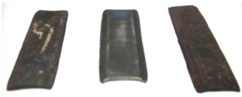
Рисунок 4 - Внешний вид заготовок ножей ротационных косилок
