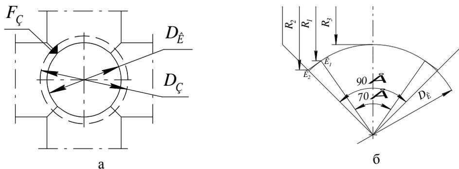
Рисунок 3 – Калибровка валков с четырехсторонним обжатием
