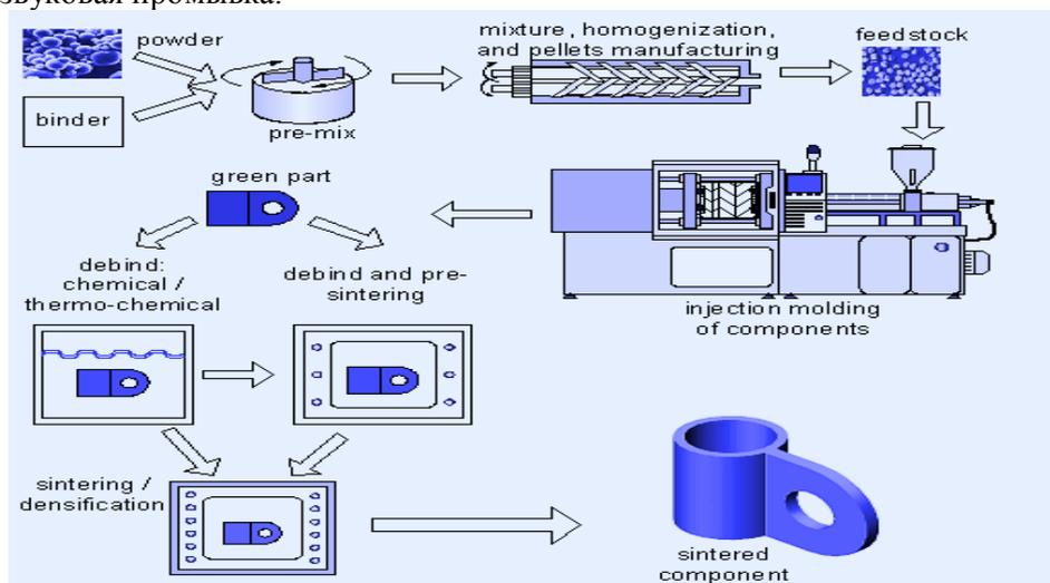
*Точность допусков и размеров.* СИМ технология позволяет получать детали с минимальной толщиной сечения от 0,5 до 30 мм с допусками в пределах 0,1мм на каждые 25 мм линейных размеров детали.
