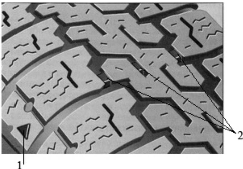
Рис. 2.11 Индикаторы износа шин:
