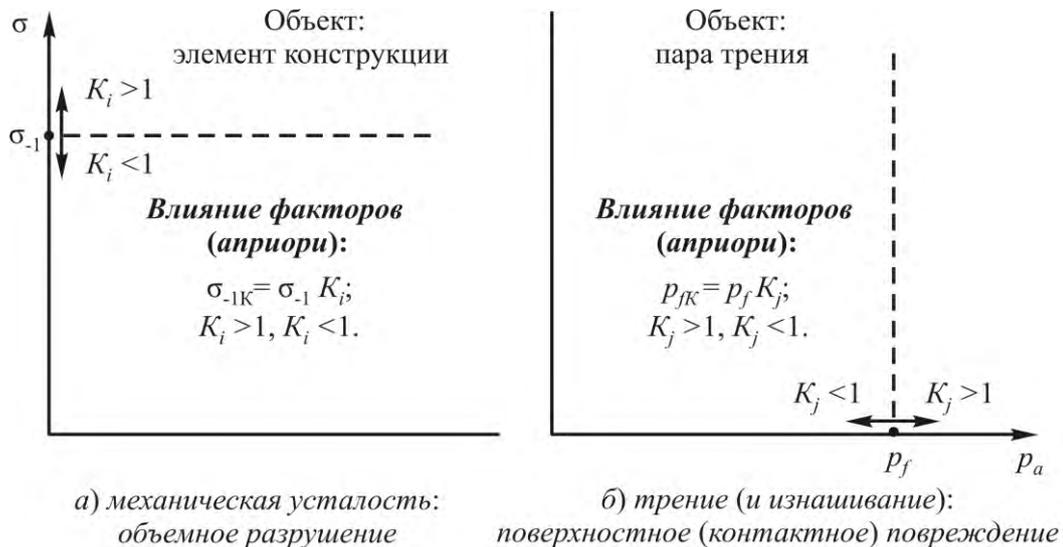
Рис. 1. Схема анализа факторов, которые влияют на изменение характеристик сопротивления усталости (а) либо износостойкости (б)
