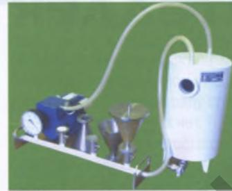
■ Предназначено для проведения санитарно-бактериологического анализа воды, водных растворов и суспензий. Изготавливается под диаметр мембран 35 и 47 мм. Емкость воронки – 500 мл.
