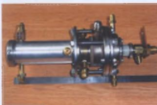
■ Генерирует пароводяную плазму (невзрывоопасная и высокоэнтальпийная среда) для газификации твердых топлив, уничтожения вредных веществ и отходов и их переработки.
