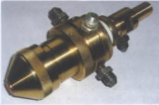
■ Работает в составе комплексов плазменной резки и используется для машинной воздушно-плазменной резки листовых металлических материалов толщиной до 50 мм. Мощность – 50 кВт.
