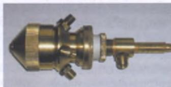
■ Является составной частью комплексов плазменной резки. Осуществляет машинную воздушно-плазменную резку листовых металлических материалов толщиной до 80 мм. Мощность прибора – 75 кВт.
