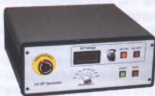
■ Предназначен для генерации «холодной» плазмы (температура до 2500°С) для технологических нужд. Частота преобразования 1 МГц, напряжение в режиме поджига до 25 кВ, напряжение в режиме ограничения дуги до 4 кВ и к.п.д. до 0,7.
