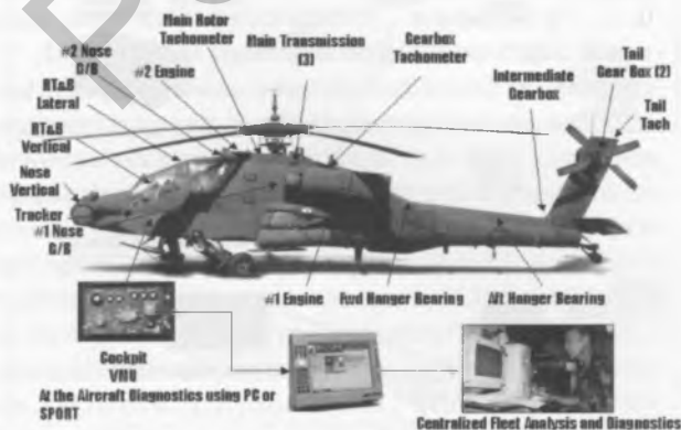
Рисунок 2 — Конфигурация системы VMEP для вертолета AH-64A [30]
