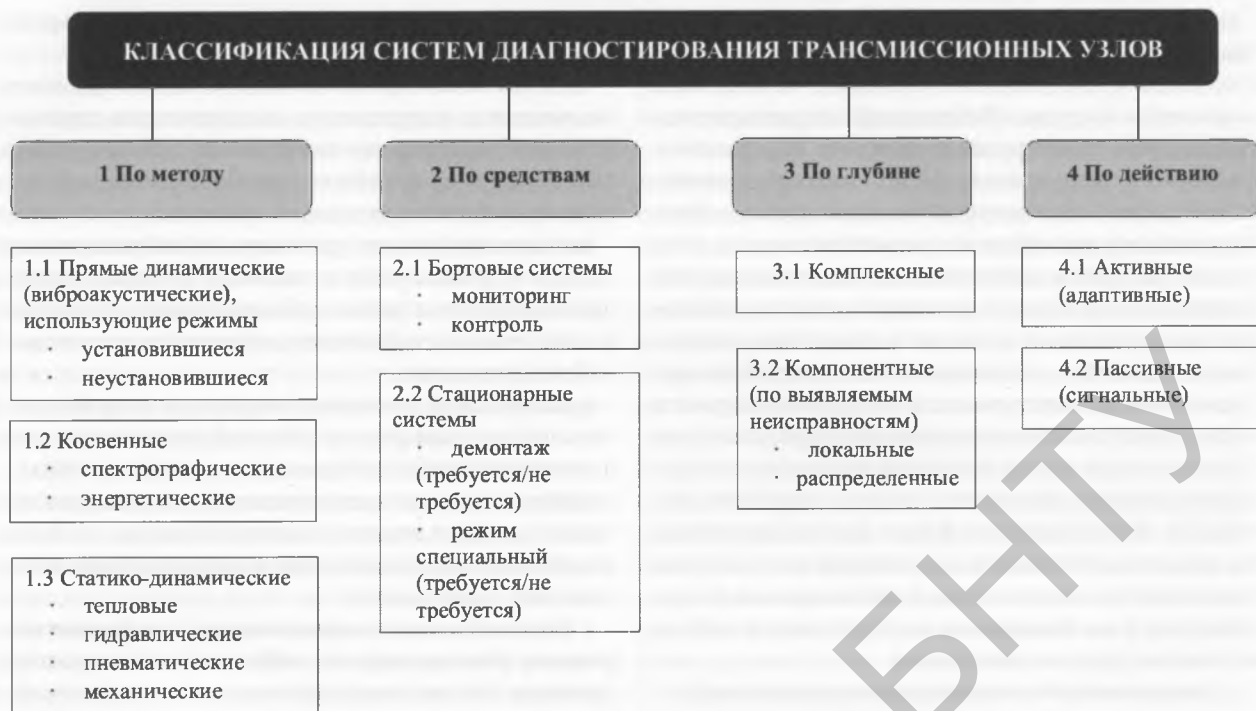
Рисунок 6 — Классификация систем диагностирования трансмиссионных узлов в эксплуатации
