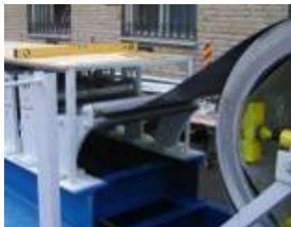
1. Заправка рулонной стали в прокатный стан
