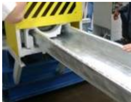
2. Прокатка прямого (стенового) профиля
