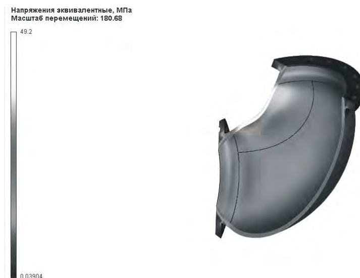
Рис. 6. Анализ максимальных напряжений разрез
