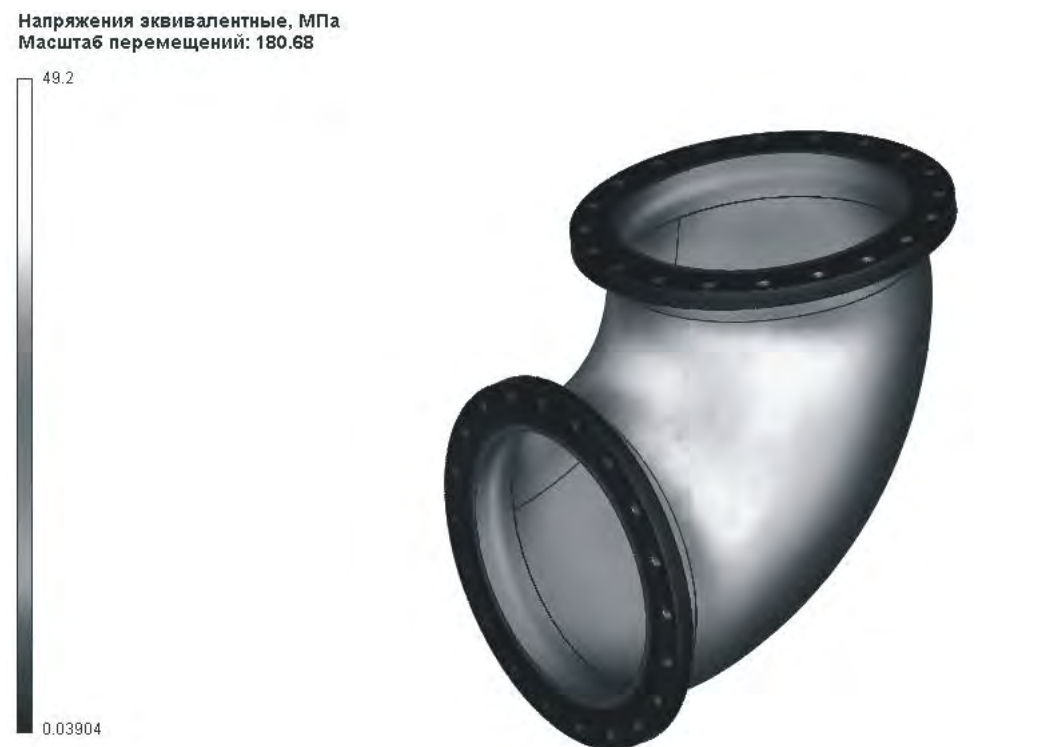
Рис. 5. Анализ максимальных напряжений
