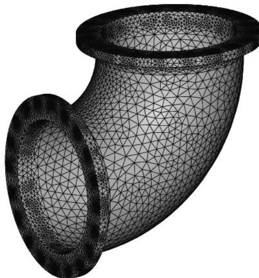
Рис. 3. Конечно–элементная сетка отвода магистрального трубопровода
