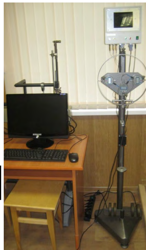
Рис. 2. Кинематические схемы и общие виды установок СМ-6МР (а) и СМ-6МК (б) после модернизации 1 – исследуемые образцы (рама, кольцо); 2 – кронштейны крепления образцов; 3, 4, 5 – цифровые датчики перемещений; 6 – нагрузочные рычаги; 7 – подвесы гиревые; 8 – стойки; 9 – наборы грузов; 10 – основания; 11 – преобразователи интерфейса; 12 – цифровые пульты оператора; 13 – персональные компьютеры
