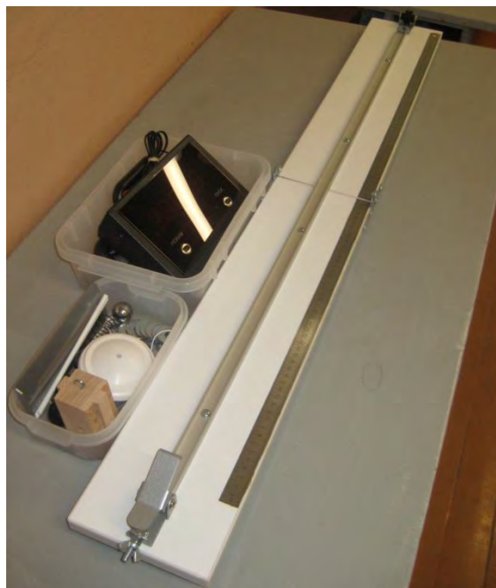
Рис. 3. Тематический лабораторный комплект для изучения законов механики
