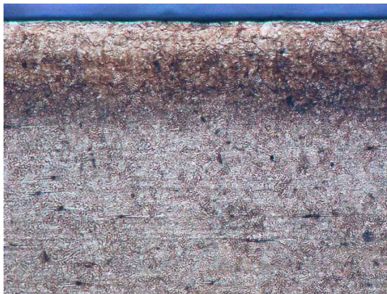
Рисунок 1 – Микроструктура стали 38X2MЮА, подвергнутой ИПА, \times 100
