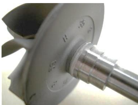
Рисунок 1 – Внешний вид ротора турбокомпрессора с колесом из сплава Inconel 713С и валом из стали 40Х после ЭЛС
