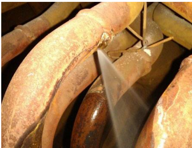
Внешний вид разрушения в области сварного соединения (свищ) на первой ступени экономайзера
