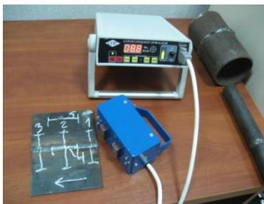
Рисунок – Внешний вид магнитного структуроскопа
