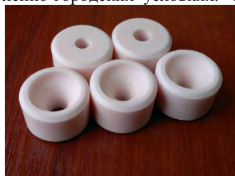
Рисунок 1 – Дюзы для риммеров подземной проходки грунтов
