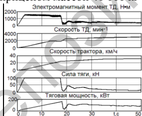
Рисунок 12. – Диаграмма временных процессов ( Slope=40 \text{ Гц/с} )
