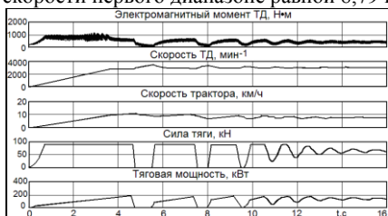
Рисунок 10. – Диаграмма временных процессов ( K_{sh} = 20000 \text{ Н·м·с/рад} )
