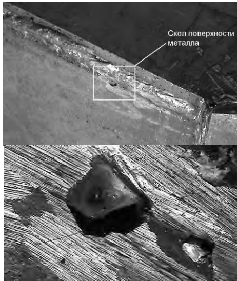
Рис. 2.15. Повреждение образца № 3 в результате испытаний (в реальном и увеличенном масштабе)
