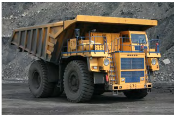
Рис. 5.26. Карьерный самосвал БелАЗ-75131 грузоподъемностью 130 тонн
