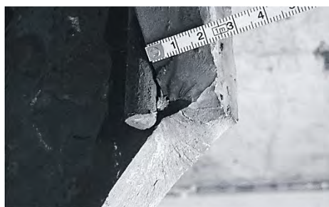
Рис. 2.13. Поверхность излома сварного образца № 1 с угловыми швами с разделкой кромки бокового листа (непровар 10 мм)
