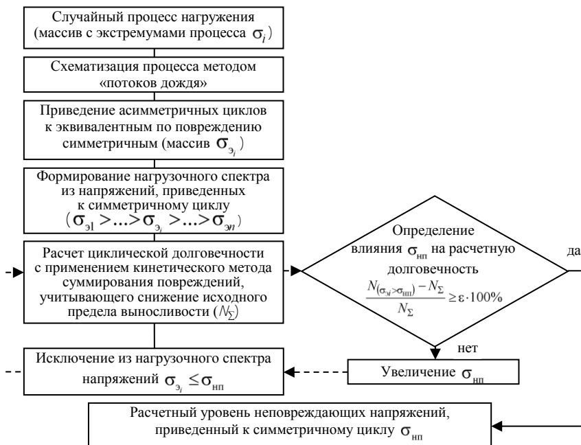
Рис. 3.7. Алгоритм определения уровня неповреждающих напряжений случайного процесса нагружения
