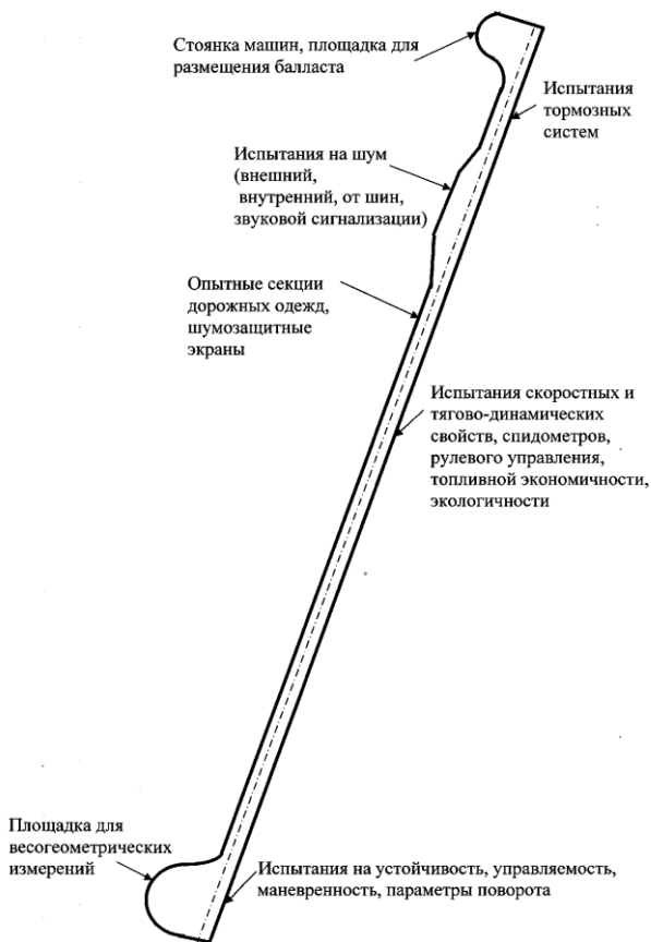
Рис. 6.3. Схема динамометрической дороги и измерительных площадок
