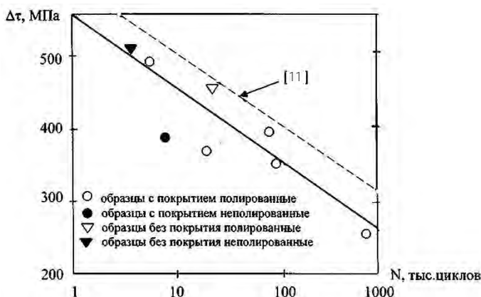
Рис. 1.12. Влияние никель-хромового покрытия на сопротивление усталости среднеуглеродистой стали при кручении (сплошная линия определена регрессионным анализом результатов испытаний образцов с покрытием)
