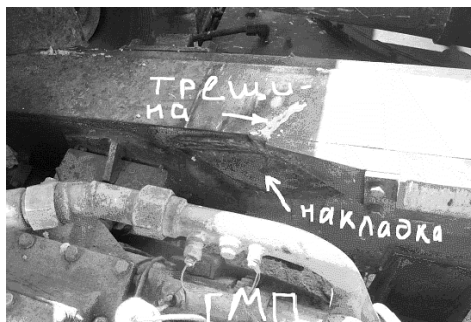
Рис. 2.12. Повреждение левого лонжерона БелАЗ-7555В (после ремонта)
