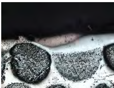
Рис.1 Композиционный материал полученный с помощью индукционного нагрева
