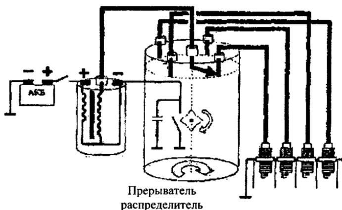
Для учета режима работы двигателя предусмотрены механизмы корректировки угла опережения зажигания – центробежный и вакуумный регуляторы.
