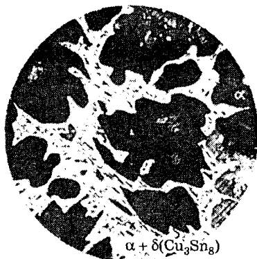
Рис. 7.9. Структура бронзы с 10 % Sn
