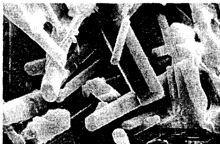
Рис. 8.2. Микроструктура волокнистого упрочнителя
