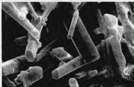
Рис. 7.2. Микроструктура волокнистых упрочнителей
