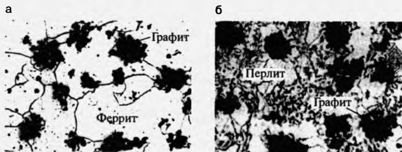
Рис. 13.7. Структуры ковкого чугуна: а — ферритный; б — перлитный
