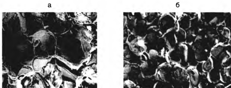
Рис. 8.4. Поверхности излома спеченных порошковых материалов ( а ) и образование межчастичного контакта в условиях жидкофазного спекания ( б )
