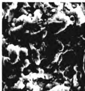
Рис. 8.5. Псевдожидкая фаза на поверхности излома нитрида титана
