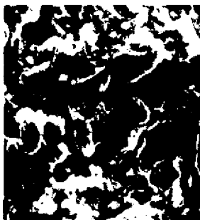
Рис. 8.5. Псевдожидкая фаза на поверхности излома нитрида титана
