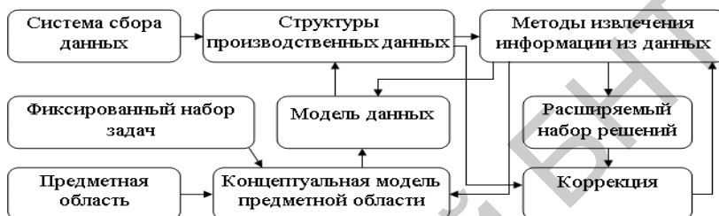
Рисунок 1. - Схема информационной модели для производственного управления на уровне АСУТП, основанной на модели данных
