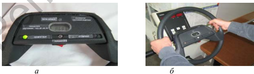
Рисунок 8. – Измерение функционального состояния оператора с помощью контрольно-измерительной аппаратуры, встроенной в рулевое колесо
