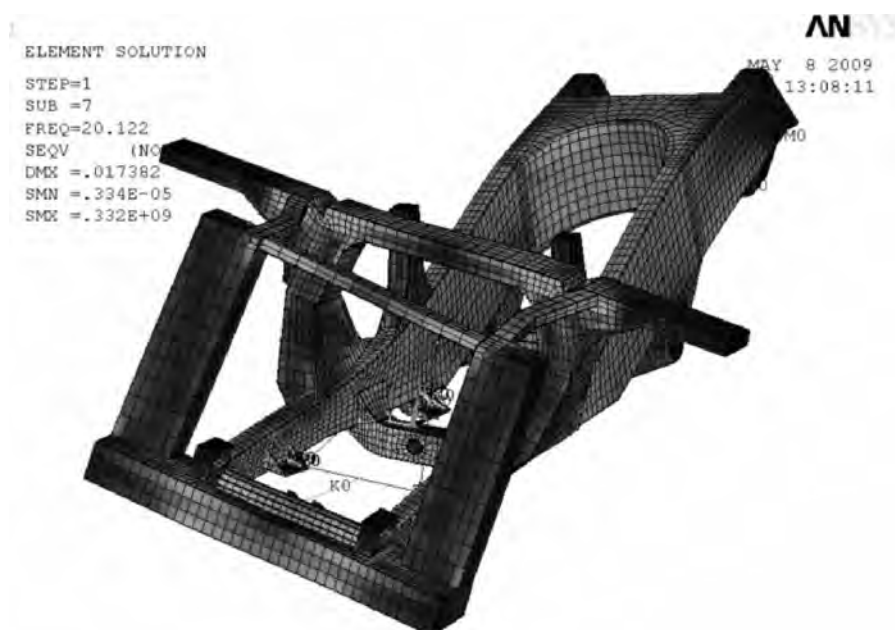
Рис. 4. Первая форма собственных колебаний рамы в незакрепленном состоянии.
