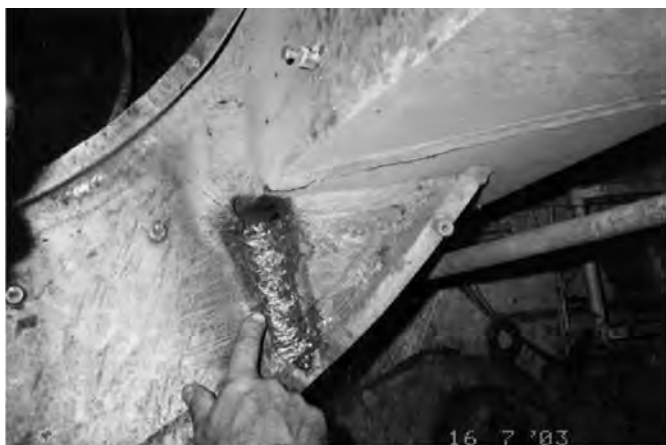
Рис. 2. Следы ремонта разрушенного соединения второй нижней поперечины с лонжероном на раме самосвала БелАЗ-75131.
