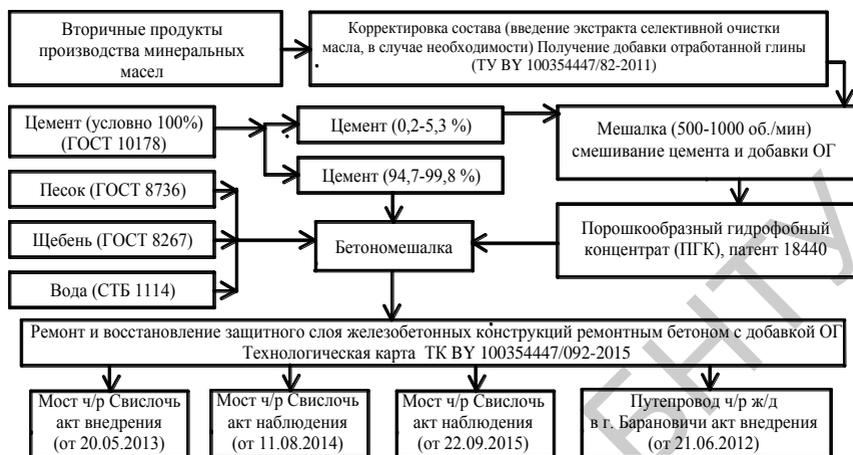
**Рисунок 8. – Схема получения и применения ремонтных бетонов**
