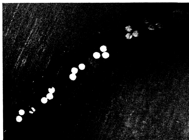
Рис. 11. Поперечное сечение резинометаллокордового полотна
