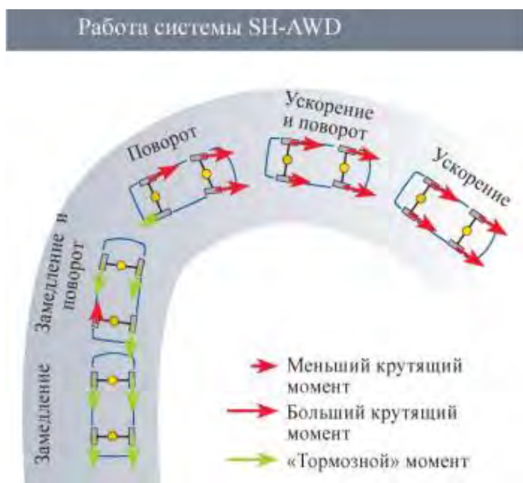
Рисунок 4 — Работа системы SPORT HYBRID SH-AWD.
