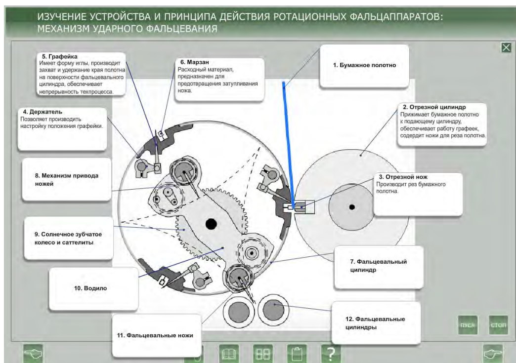
Рисунок 3 – Скриншот экрана стенда для детального изучения фальцевального цилиндра
