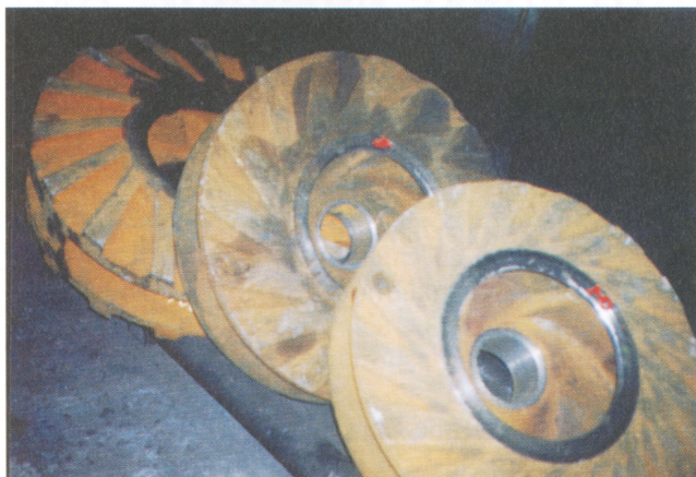
Рабочие колеса из сплава ИЧХ28Н2 к насосам типа ГРА
