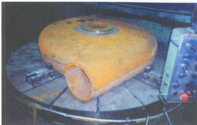
Корпус внутренний к самому крупному насосу ГРТ 4000/71 из ИЧХ28Н2. Масса отливки 2100 без прибылей
