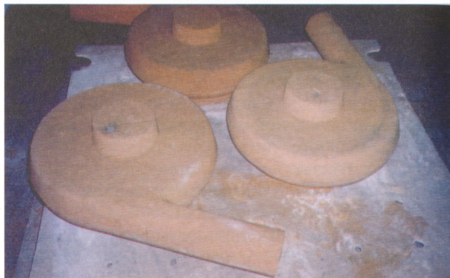
Стержни из ХТС фирмы «Полисет» для корпусов внутренних ГРА 170/40
