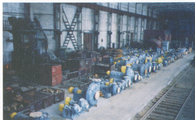
Склад готовой продукции. Насосы грунтовые ГРА
