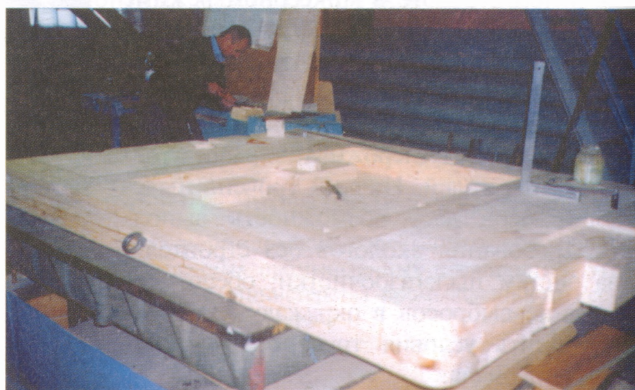
Модельный участок. Врезка для формовочной машины 22506 к насосу ГРА 1400/40
